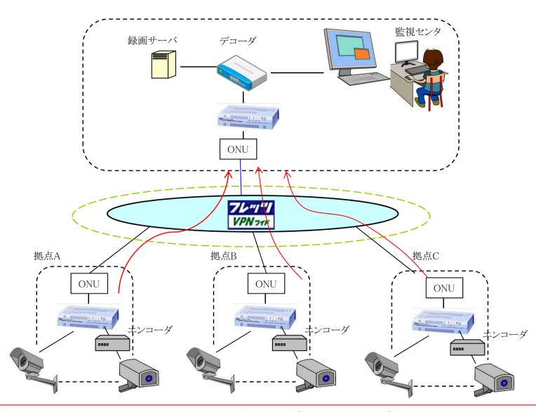
カメラ信号がマルチキャストの場合、FNX0630の各LANポートはWANポートのみ通信させる設定を行うことで、他のLANポートへマルチキャストパケットを出力させないようにすることができます。
