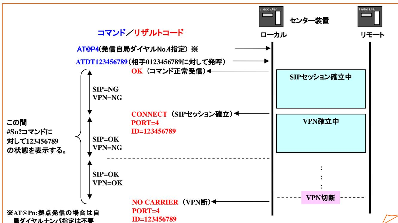
・ AT コマンド (発信、正常接続、着側から切断)
