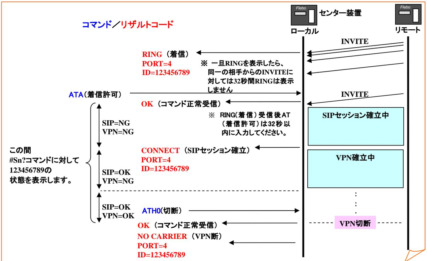
・ AT コマンド (発信、正常接続、着側から切断)
