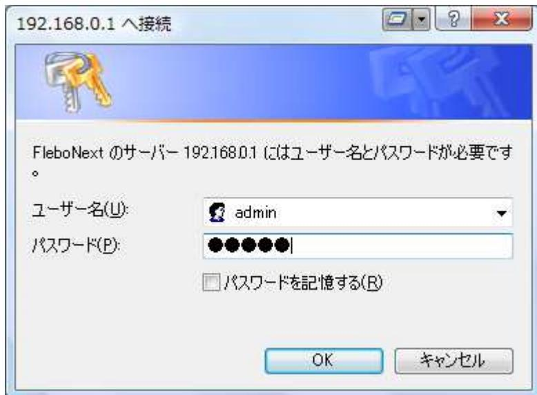
本装置にログインするためのパスワードを変更しない場合、管理/拡張ポートから誰でも本装置の設定を変更することができます。セキュリティの面から非常に危険なため、パスワードを変更してご使用になることを強く推奨します。パスワードの変更は、本書「6.8 管理者設定」の「(10) パスワード変更」を参照してください。
