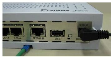
図② 電源コード取付状態
