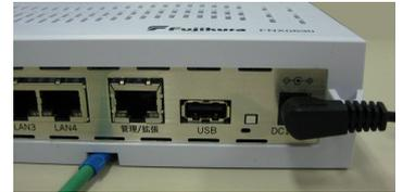
図② 電源コード取付状態
