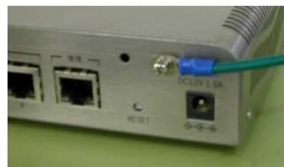
図 FGケーブル取り付け状態
